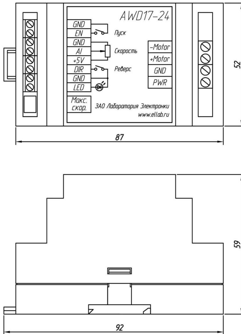
Рисунок 2 – Габаритные размеры блока управления в корпусе на DIN рейку
